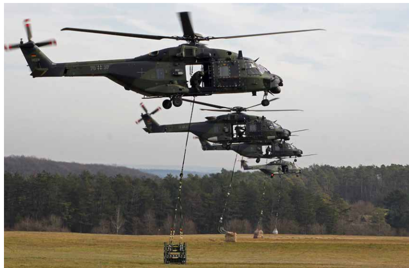
Gleichzeitiges Aufnehmen oder Absetzen von Außenlasten reduziert beim taktischen Fliegen die Zeit am Einsatzort. Je schneller das geht, desto schneller sind die Hubschrauber wieder aus der Bedrohungszone verschwunden.
